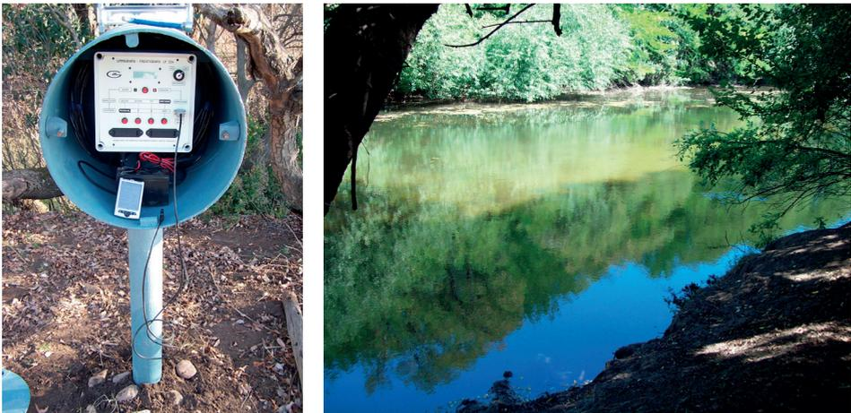
**Figura 4.** a) Abrigo y consola de registro Estación Limnigráfica L1, b) Sección de aforo donde se encuentra instalado el sensor de nivel de L1 en el río Sauce Grande.
